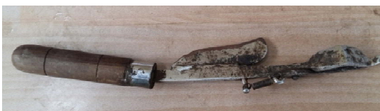
Fig. 3. IISR Sugarcane detrasher cum detopper
