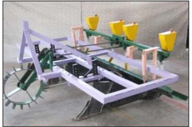
ट्रैक्टर चालित चुकंदर उठी हुई बेड प्लॉन्टर
