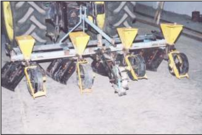
ट्रैक्टर द्वारा खींची गई चुकंदर रिज प्लॉन्टर
